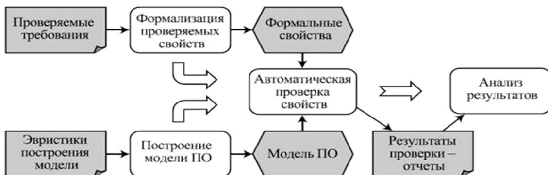
Рис. 1.2. Схема процесса проверки свойств ПО на моделях
