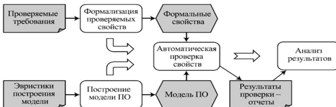
Рис. 1.2. Схема процесса проверки свойств ПО на моделях
