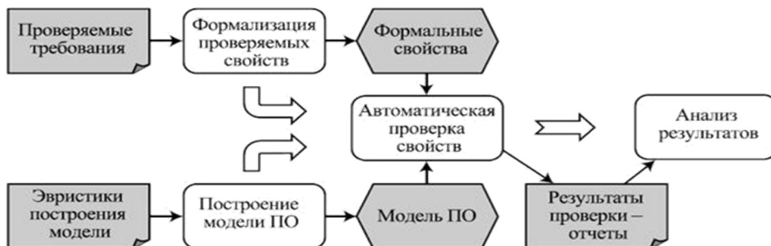
Рис. 1.2. Схема процесса проверки свойств ПО на моделях
